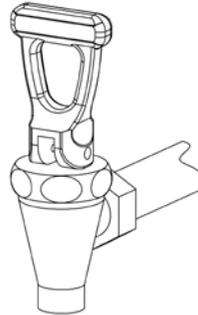
Zeigt der Hebel senkrecht nach oben, ist der Ablasshahn geschlossen.
