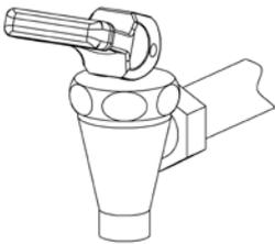
Wird der Hebel nach unten gedrückt, ist der Ablasshahn geöffnet.
